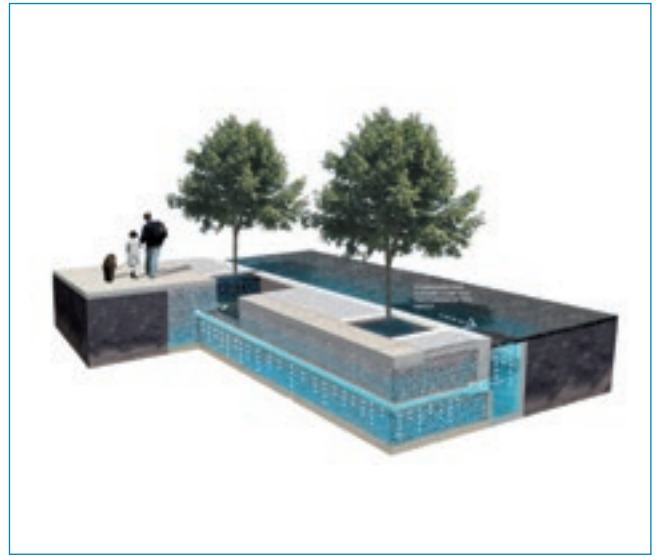
30 Pflanzgrube mit erweitertem Speichervermögen
