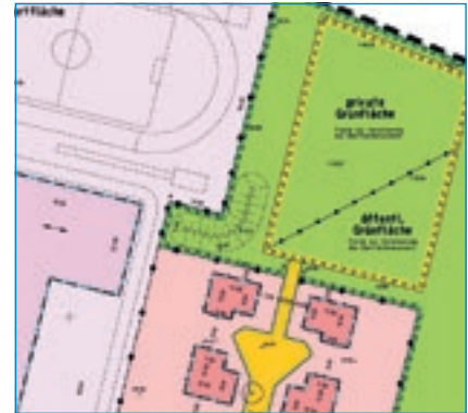
83 Festsetzung einer zentralen Versickerungsfläche in einem Wohngebiet
