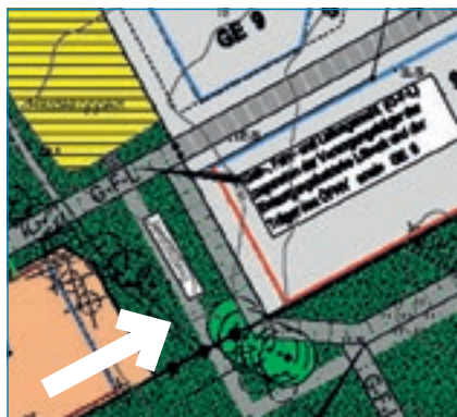
87 Sicherung eines Notwasserweges über GFL Rechte
